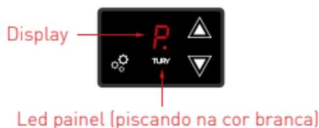
Feito isso o módulo automaticamente retorna para o modo original, mas já com o aprendizado do pedal do acelerador finalizado. Se não pisar no acelerador em até 10 segundos do início do led piscando, sairá do aprendizado, sendo necessário repetir o procedimento
