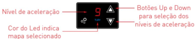
Pode-se selecionar qualquer nível de ajuste em cada um dos 4 mapas de aceleração. Quanto maior o nível, maior o ganho de resposta de aceleração. Para retornar ao modo original de aceleração do veículo basta tocar em settings, após o 4º mapa (Led Azul). Desta forma o painel ficará totalmente apagado, indicando que esta no modo original do veículo. Para ligar novamente, basta um novo toque no botão settings e irá ao Mapa 1 (amarelo).
